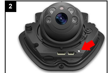
2 Für Reset: Fünf Sekunden lang die Taste gedrückt halten.
