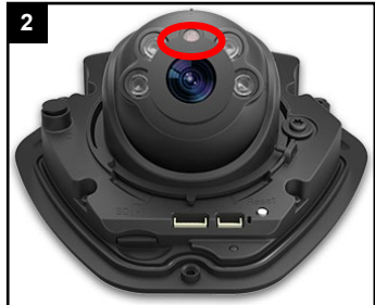
2 Die Kerbe im Schaumstoff-Ring muss an den Lichtsensor ausgerichtet sein.
