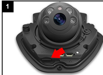
1 Der Kartenslot befindet sich unter der Haube.
