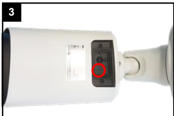
3 Für Reset: Fünf Sekunden lang die Taste gedrückt halten.
