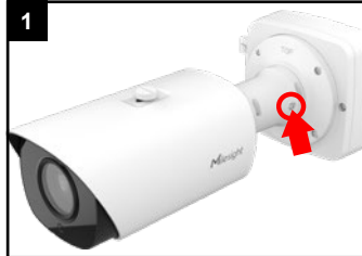
1 Die hier markierte Verschraubung am Wandarm mit zwei bis drei Umdrehungen lockern. Nicht komplett lösen. Gegebenenfalls Schraube ein wenig eindrücken.
