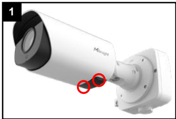
1 Schrauben an unterer schwarzer Abdeckung lösen.
