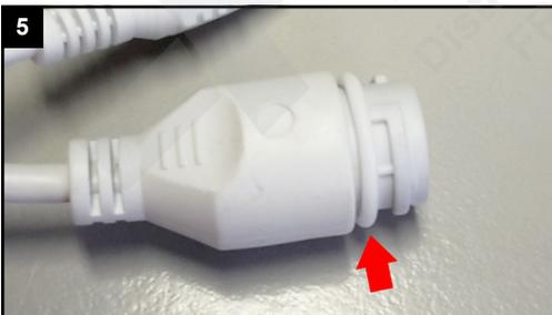
Die Dichtung muss vollständig aufliegen.
