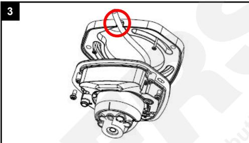
Bei seitlicher Kabelzufuhr verwenden Sie die mitgelieferte Adapterplatte „ISIS-MAB01“.
