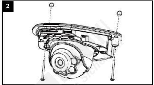
Lösen Sie die Schrauben, damit Sie die Haube der Kamera abnehmen können.
