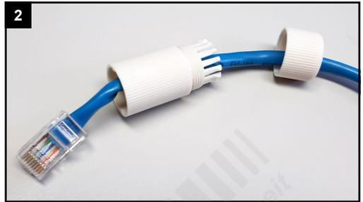
Siehen Sie die Verschraubung und den Schraubbolzen nacheinander über das Kabel, an das Sie die Kamera verbinden möchten.
