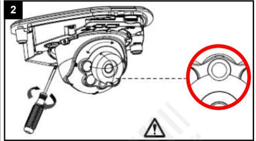
Lösen Sie die Befestigungs-Schrauben und richten die Kamera in die gewünschte Blickrichtung aus. Ziehen Sie die Schrauben anschließend fest, um die Blickrichtung zu fixieren.
