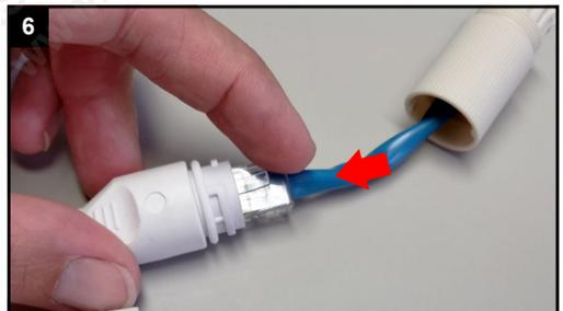
Verbinden Sie den Netzwerkstecker mit dem Netzwerkanschluss-Verbinder am Kamerakabel.
