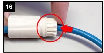
Dichtung in den Schraubbolzen pressen.
