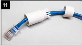
Verschraubung und Schraubbolzen über das Kabel ziehen.
