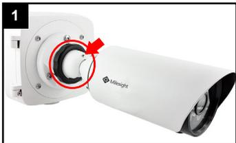
Den schwarzen Ring und Befestigungsschraube ein wenig lockern, bis Sie die Kamera drehen können.
