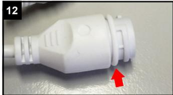
O-Ring auf Netzwerkbuchse am Kabel der Kamera setzen.
