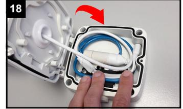
Verkabelung vollständig in die Anschlussbox legen und Deckel schließen.
