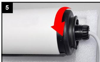
Kamera-Rückseite entgegen dem Uhrzeigersinn lösen.
