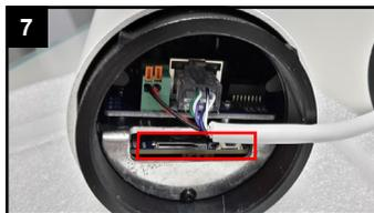
Der Kartenslot befindet sich hinter der Rückwand.
