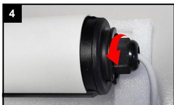
Verschraubung entgegen dem Uhrzeigersinn lösen.
