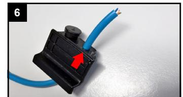
Kabel durch die Dichtung ziehen.
