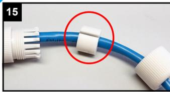
Kabel durch den seitlichen Schlitz in die Dichtung pressen.
