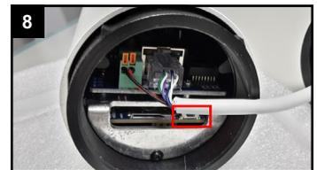
Für Reset: Fünf Sekunden lang die Taste gedrückt halten.
