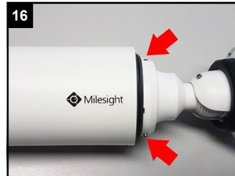
16 Kamera an den Halter drücken und die drei Inbus-Verschraubungen anziehen.
