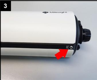
Untere Befestigungsschraube etwas lockern (2 - 3 Umdrehungen).
