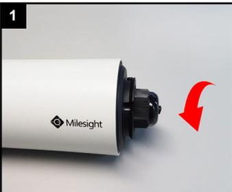
Schwarze Verschraubung auf der Rückseite der Kamera abschrauben.
