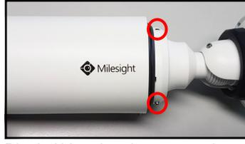
Die drei Verschraubungen an der Kamera ein wenig lockern, bis sich diese drehen lässt.
