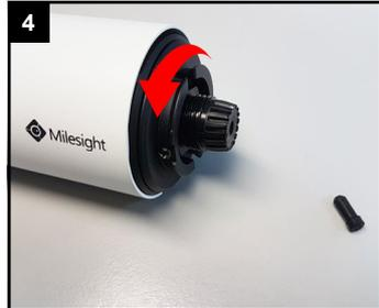
Schwarze Rückwand durch Abschrauben lösen.
