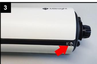
Untere Befestigungsschraube etwas lockern (2 - 3 Umdrehungen).
