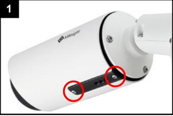
Schrauben an unterer schwarzer Abdeckung lösen.
