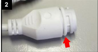
O-Ring auf Netzwerkbuchse am Kabel der Kamera setzen.
