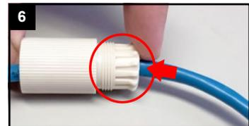
Dichtung in den Schraubbolzen pressen.
