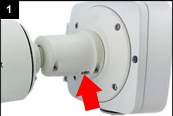
Die hier markierte Verschraubung am Wandarm mit zwei bis drei Umdrehungen lockern. Nicht komplett lösen. Gegebenenfalls Schraube ein wenig eindrücken.
