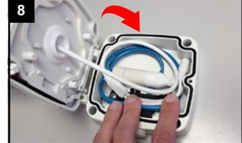
Verkabelung vollständig in die Anschlussbox legen und Deckel schließen.
