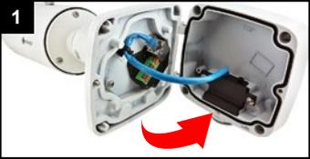
Kabel verbinden und Deckel schließen
