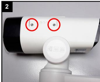
Schrauben an seitlicher Abdeckung lösen.
