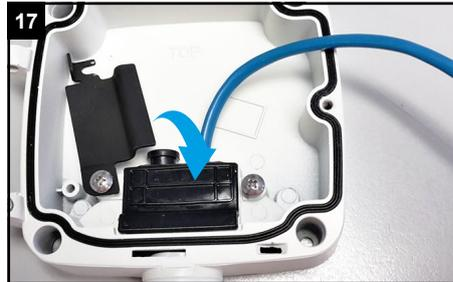
17 Schwenken Sie die schwarze Platte zurück auf die Dichtung und ziehen Sie die beiden Schrauben wieder fest.
