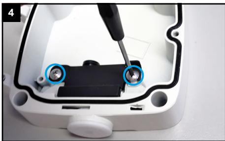
Lockern Sie mit zwei bis drei Umdrehungen die beiden Schrauben an der schwarzen Platte. Schrauben nicht komplett herausziehen.
