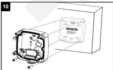
Befestigen Sie die Anschlussbox mit dem Dübeln und den Schrauben an einer Wand. Prüfen Sie auch, ob die Wand das Gewicht von Anschlussbox und Kamera halten kann.
