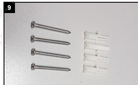
Befestigen Sie die Anschlussbox mit dem Dübeln und den spitzen Schrauben M4x40 aus dem Beutel.
