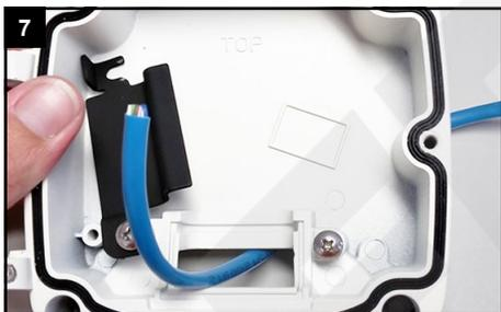
Ziehen Sie die Verkabelung durch die Rückseite der Anschlussbox.
