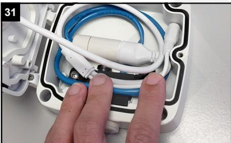
31 Legen Sie die Verkabelung vollständig in die Anschlussbox.
