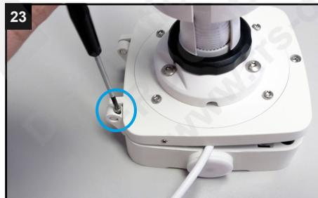
23 Klappen Sie den Deckel leicht zu, ohne die Verkabelung zu beschädigen. Schrauben Sie die Schraube für das Scharnier wieder ein. Die Schraube verhindert das Lösen des Deckels.
