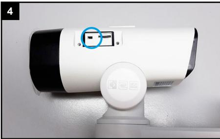
Für einen Reset: Betätigen Sie die Reset-Taste fünf Sekunden lang, wenn Sie die Kamera auf ihre Werkseinstellungen zurücksetzen möchten.
