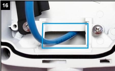
16 Die Dichtung muss vollständig in der dafür vorgesehenen Position hineingepresst werden.
