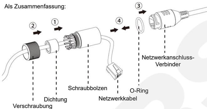
1. Verschraubung, Dichtung und Schraubbolzen über das Kabel ziehen.
