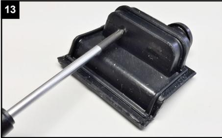
13 Stechen Sie mit einem spitzen Gegenstand ein kleines Loch durch die Stelle, an der Sie das Kabel hindurchziehen möchten.
