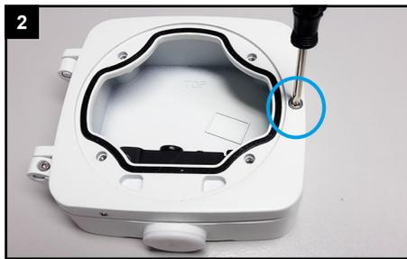
Lockern Sie an der Anschlussbox die Schraube, bis Sie den Deckel öffnen können.
