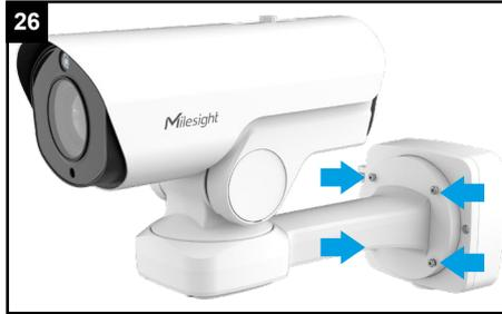
26 Ziehen Sie die Verkabelung der Kamera durch die Öffnung im Deckel und schrauben Sie die Kamera mit den vier Schrauben am Deckel fest.
