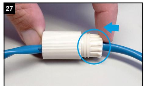
27 Pressen Sie die Dichtung vorsichtig und gleichmäßig in den Schraubbolzen.
