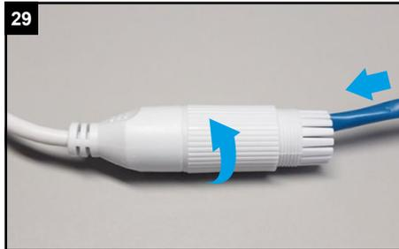
29 Schieben Sie den Schraubbolzen zum Kamerakabel und schrauben Sie diesen fest.
