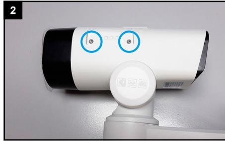
Lösen Sie die beiden seitlichen Schrauben an der Abdeckung.
