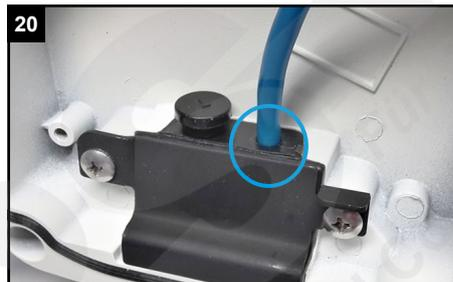
20 Wenn möglich verwenden Sie etwas Dichtungsmittel, um die Stelle zusätzlich abzudichten, damit keine Luftfeuchtigkeit in die Anschlussbox gelangen kann.
