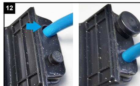
**Hinweis:** Verwenden Sie erst bei einem dicken Kabel (circa 7mm Querschnitt) die größere Kabelzufuhr der Dichtung, damit kein unnötiger Spielraum zum Eindringen von Luftfeuchtigkeit gelassen wird.
