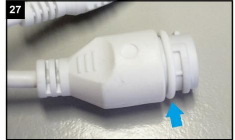
27 Ziehen Sie den Dichtungsring auf die Buchse am Anschlusskabel der Kamera.
