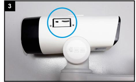
Nehmen Sie die Abdeckung ab. Links befindet sich die Reset-Taste und rechts der Kartenslot.
