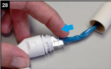
28 Verbinden Sie den Netzwerkstecker mit dem Netzwerkanschluss-Verbinder am Kamerakabel.
