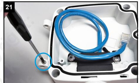
21 Lösen Sie die Schraube am Scharnier der Anschlussbox.
