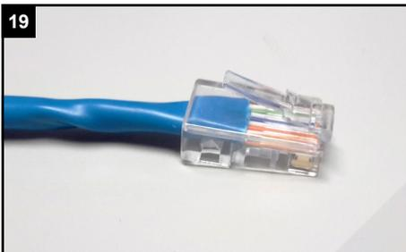
19 Befestigen Sie einen RJ45 Netzwerkstecker am Kabel.
